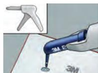
レストラティブディスペンサーにセットして試し出しをします。
