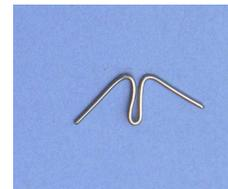
鉤腕部を凹部の溝で片翼づつ上下に屈曲する。
