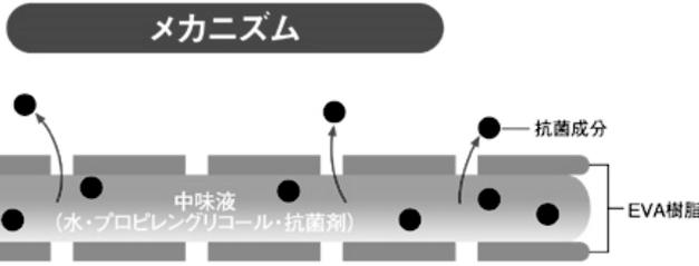
EVA樹脂は他ポリエチレン系樹脂と比較し、水蒸気透過度が非常に高い化学的性質を兼ね備えています。ウォーターインソールの樹脂(EVA樹脂)には目には見えないミクロン単位の非常に小さな穴があいており、その穴から中身液(水・プロピレングリコール・抗菌剤)が極めて少量づつ揮発します。この作用によって、靴内の雑菌を抑え、防臭効果が続きます。
