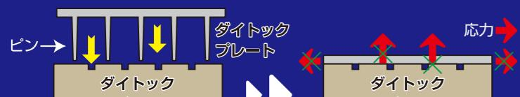
樹脂製プレートとベースは、石膏のような硬化膨張がなく応力が働くないので、
