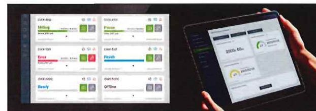
ウェブアプリを通じていつでもどこからでも、所有するDWXシリーズの稼働状況がわかります。過去のメンテナンス履歴が一覧で確認できるので、今後のメンテナンス計画の策定にも便利です。
